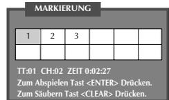
Drücken Sie die Taste [ENTER] um die Markierung aufzurufen. Oder drücken Sie die Taste [CLEAR] um die Markierung zu löschen.
