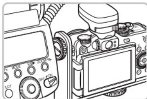
Die separat erhältliche Speedlite-Schiene SB-E2 hilft, die bei vertikalen Aufnahmen auftretenden unnatürlichen Schatten neben den Motiven zu vermeiden. Je nach Winkel kann die Schiene jedoch beim Öffnen des LCD-Monitors stören. Verwenden Sie die Kamera mit geschlossenem LCD-Monitor. Der Bildschirm muss dabei nach außen zeigen.
