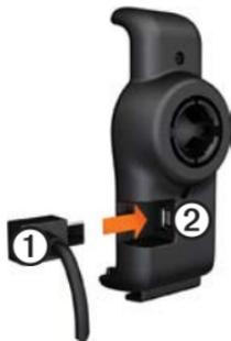
4. Schließen Sie das andere Ende des KFZ-Anschlusskabels an eine Stromquelle im Fahrzeug an.
