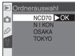
Auf dem Monitor wird an erster Stelle der aktuell ausgewählte Ordner angezeigt, gefolgt vom Standardordner »NCD70«. Danach werden alle übrigen Ordner in alphabetischer Reihenfolge aufgeführt. Der im Menü »**Ordnerauswahl**« ausgewählte Ordner bleibt auch dann ausgewählt, wenn er gelöscht wird oder eine neue Speicherkarte in die Kamera eingesetzt wird. Sobald die erste Aufnahme gespeichert wird, legt die Kamera einen neuen Ordner mit diesem Namen an.
