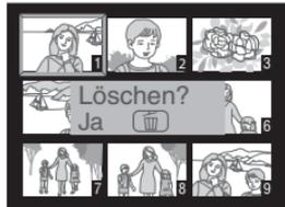
3 Drücken Sie die Taste erneut, um das Bild zu löschen. Wenn Sie das Menü verlassen möchten, ohne das Bild zu löschen, drücken Sie eine beliebige Taste.
