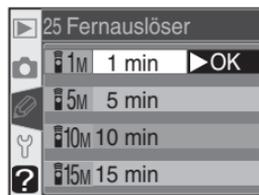
Markieren Sie im erweiterten Menü der Individualfunktionen (135) die Option »**Fernauslöser**« und drücken Sie den Multifunktionswähler rechts. Drücken Sie den Multifunktionswähler oben oder unten, um die gewünschte Option zu markieren, und anschließend rechts, um die Auswahl zu bestätigen.
