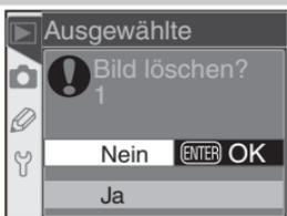
Es erscheint eine Sicherheitsabfrage. Drücken Sie den Multifunktionswähler oben oder unten, um die gewünschte Option zu markieren, und anschließend die Taste **ENTER**, um die Auswahl wirksam werden zu lassen.
