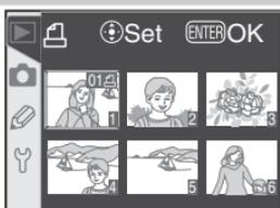
Drücken Sie den Multifunktionswähler oben, um das markierte Bild in den Druckauftrag aufzunehmen und die Anzahl der Abzüge auf 1 festzulegen. Ausgewählte Bilder werden mit dem Symbol
