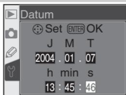
Stellen Sie Datum und Uhrzeit ein. Drücken Sie den Multifunktionswähler links oder rechts, um eine Datums-einstellung zu markieren, und anschließend oben oder unten, um den gewünschten Wert einzustellen.
