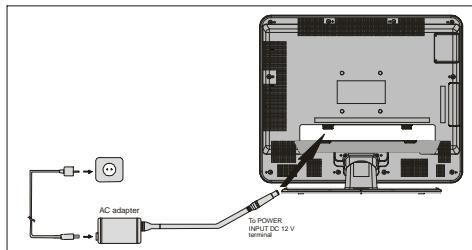
**IMPORTANTE:** L’apparecchio TV set è prodotto per funzionare su 12 V DC. Per questo, viene utilizzato un adattatore che da un voltaggio di 12V DC. Collegare tale adattatore ad un sistema che fornisce 230V AC, 50 Hz.
