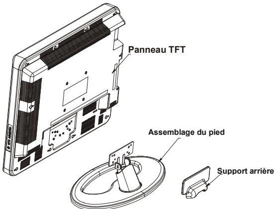
**2-** Placez les 4 cintres dans les trous à vis circulaires dans la partie arrière du TFT et vissez les au panneau TFT avec 4 vis (M4 x 10).
