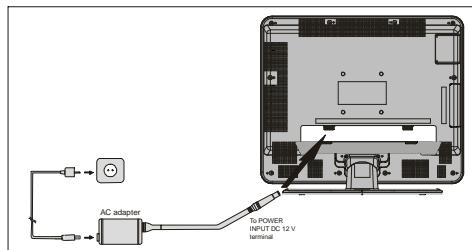
**IMPORTANT :** Ce téléviseur est conçu pour fonctionner avec une alimentation de **12 V DC**. Il est donc livré avec un adaptateur qui fournit une tension de **12V DC**. Raccordez cet adaptateur à une prise c.a. de **230 V à 50 Hz**.
