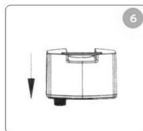
6 Riavvitare e stringere il tappo e riporre il serbatoio nel ventilatore, quindi chiudere il pannello.
