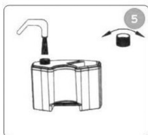
5 Svitare il tappo del serbatoio e aggiungere dell'acqua.
