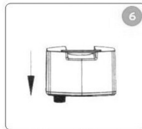
Den Wassertankdeckel fest zudrehen, den Tank in den Ventilator einsetzen und die Blende schliessen.
