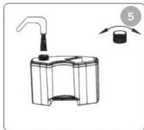
Den Wassertankdeckel abschrauben und Wasser einfüllen.
