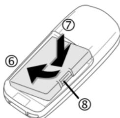
Zum Entfernen auf die Halteklappe drücken ⑧, dann den Akku herausheben. Die Abdeckung auf das Telefon setzen und auf die Oberkante drücken, bis sie einrastet ⑨.
