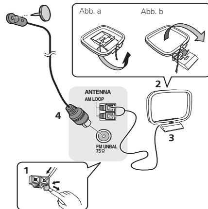
**1** Öffnen Sie die Schnappanschlüsse, führen Sie in jeden Anschluss einen der Drähte bis zum Anschlag ein und lösen Sie dann die Arretierung der Schnappanschlüsse, um die Verbindung der MW-Antennendrähte zu sichern.
