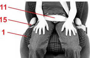
Un cojín de asiento adaptado correctamente **1** garantiza la disposición óptima del cinturón de pelvis **11**, y con ello aumenta la protección de su niño. Puede ajustar las piezas laterales **15** del cojín del asiento **1** en tres anchuras.
