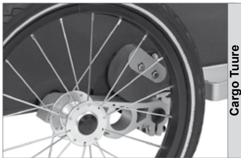
Wartungsfreie AirPad®-Federung mit Sylomer® (Cargo Tuure)
