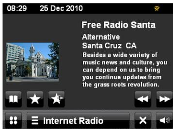
Ligne d'en-tête : date, heure, alarme, fonction "Sleep", état de la connexion réseau
