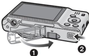
**1** Schieben Sie den Freigabehebel in Pfeilrichtung und öffnen Sie die Karten-/Akkufach-Abdeckung.
