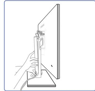
Halten Sie die hintere Abdeckung des Sockels mit der rechten Hand fest, und legen Sie das Kabel mit der linken Hand in die Nut der Abdeckung ein.
