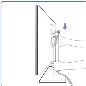
Halten Sie den Fuß des Sockels mit der linken Hand sicher fest, halten Sie die Oberseite des Sockels mit der rechten Hand, und drücken Sie dann mit dem Daumen der rechten Hand die hintere Abdeckung des Sockels nach unten.
