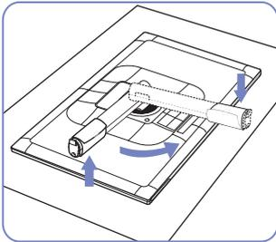
Legen Sie als Schutz ein Tuch oder Polster auf eine ebene Oberfläche. Legen Sie das Gerät anschließend mit der Vorderseite nach unten oben auf das Tuch bzw. Polster. Verdrehen Sie den Standfuß um ca. 90°.
