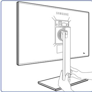
Drücken Sie die hintere Abdeckung des Sockels mit beiden Händen in die Richtung des **PUSH**-Pfeils.
