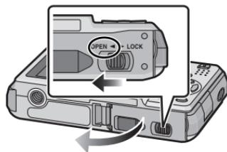
**2** Batteria: Inserire fino in fondo, facendo attenzione che sia orientata correttamente. Tirare la leva (A) nella direzione della freccia per rimuovere la batteria.
