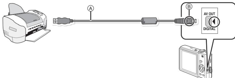
Ⓐ Cavo di connessione USB (in dotazione)
