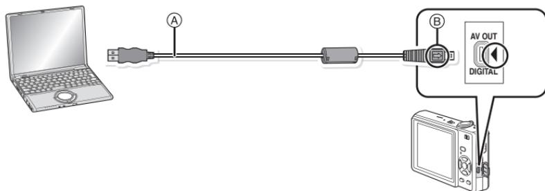
(A) Cavo di connessione USB (in dotazione)
