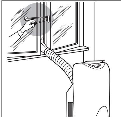
Coincer l'extrémité de la gaine dans la fenêtre entrouverte, à l'aide de l'attache avec ventouse.
