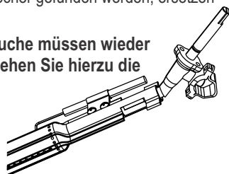
Die korrekte Verbindung vom Brenner zum Ventil
