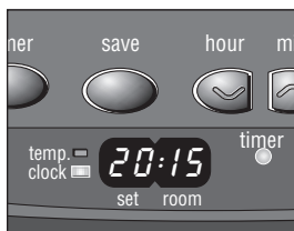
H: La spia luminosa di controllo TIMER indica che la funzione del timer è attiva.
