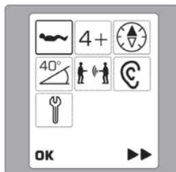
Wenn das S1 ein hörbares (Lautsprecher) und sichtbares Signal (Kreis mit 2 Personen) von jedem einzelnen VS-Gerät empfängt, ist die Sendefunktion des überprüften Gerätes und die Empfangsfunktion des Gruppenleiters in Ordnung.
