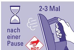
**WICHTIG:** Bevor Sie mit dem Bügeln beginnen bzw. nach einer längeren Pause drücken Sie in einem gewissen Abstand zur Bügelwäsche zwei oder drei Mal auf die Dampftaste des Bügelleisens. Dadurch wird das Kondensationswasser des Bügelleisens freigesetzt, und es werden Wasserflecken auf der Kleidung verhindert.
