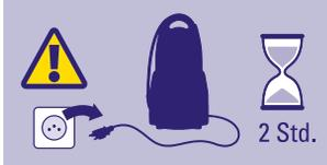
**WARNUNG:** Vor der Reinigung Gerät außer Betrieb setzen! Schalten Sie das Gerät aus und ziehen Sie den Netzstecker! Lassen Sie Ihr Gerät mindestens zwei Stunden abkühlen. Die Reinigung erfolgt immer an einem kalten Gerät, am besten vor der Verwendung!
