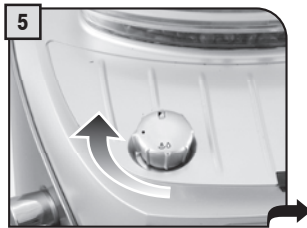
5 Draai de knop tot op de ruststand (●).
