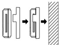
1. Zur korrekten Platzierung der Bohrlöcher markieren Sie an der Wand mit einem Stift durch die Löcher des Halters deren Position.
