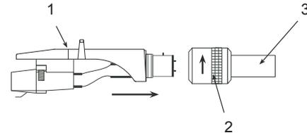
Fissare la testina sul braccio del pick-up girando l'anello filettato 2 in senso orario, mentre la testina rimane orizzontale.
