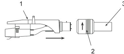
Sichern Sie den Tonarmkopf auf dem Tonarm, indem Sie den Schraubring 2 im Uhrzeigersinn drehen, während Sie den Tonarmkopf waagrecht halten.
