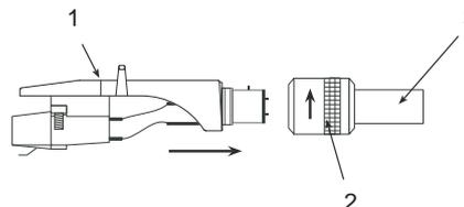
Tout en maintenant la coquille du bras de lecture à l'horizontale, fixez la coquille sur le bras de lecture en tournant la bague fileté 2 dans le sens des aiguilles d'une montre.
