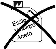
**Wichtig:** Die Maschine darf **niemals mit Essig entkalkt werden**, da sie sonst Schaden nimmt! Der Entkalkungsvorgang läuft automatisch ab und kann nicht unterbrochen werden.
