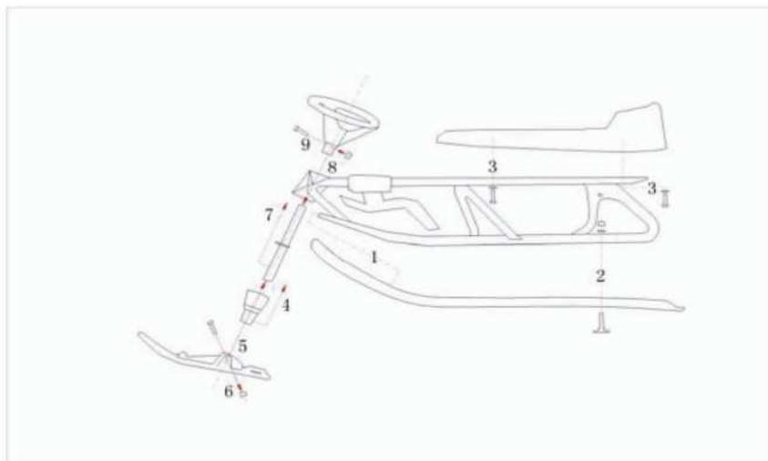
1. Die beiden Ski links und rechts, an der Unterseite des Rahmens anlegen. **(Schritt 1)**
