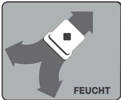
Beim Feuchtwischen fährt der Braava zuerst über eine kurze Distanz in eine Richtung, setzt dann ein Stück zurück und wiederholt diese Bewegung mit leichter Abweichung in die andere Richtung. So pendelt das Gerät während des Reinigungsvorgangs nach links und rechts.
