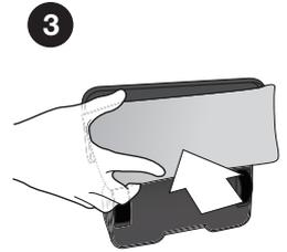
**⚠ ACHTUNG:** Stellen Sie sicher, dass das Reinigungstuch nicht den Mittelkanal zwischen den Haltestreifen des Gerätes verdeckt, da dies die Sensorfunktionen und den sicheren Betrieb beeinträchtigt.
