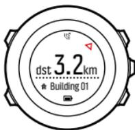
Se si è fermi o se ci si muove lentamente (<4 km/h), l'orologio indica la direzione del PDI (o della tappa intermedia se si naviga un itinerario) sulla base del GPS.
