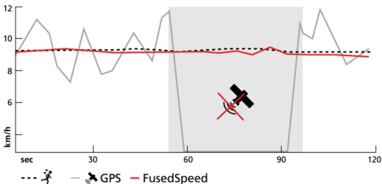
FusedSpeed può essere particolarmente utile quando serve grande reattività nella lettura della velocità durante l'allenamento, ad esempio quando si corre su terreni accidentati o durante l'allenamento intervallato. Se si perde temporaneamente il segnale GPS, ad esempio, Suunto Ambit3 Sport è in grado di continuare a fornire precisi dati di velocità grazie all'accelerometro calibrato GPS.
