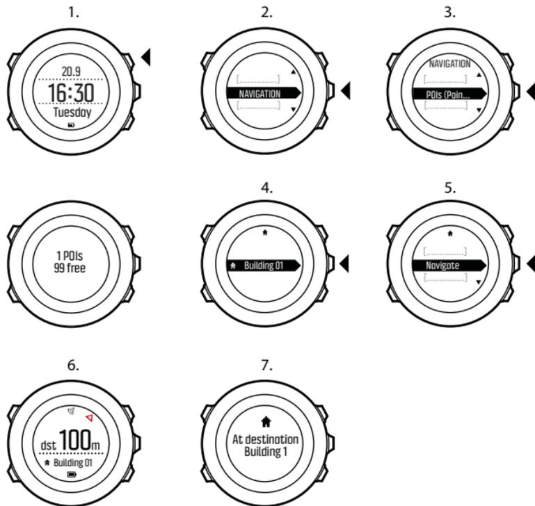
Se si è fermi o se ci si muove lentamente (<4 km/h), l'orologio indica la direzione del PDI (o della tappa intermedia se si naviga un itinerario) sulla base del rilevamento della bussola.
