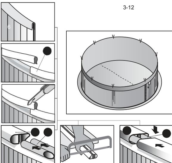
Nota: Gli inserti di collegamento oggetto della fornitura [2] sono in due forme: gli inserti senza taglio longitudinale sono indicati per la cornice inferiore, gli inserti (elastici) con taglio longitudinale sono indicati per la cornice superiore.
