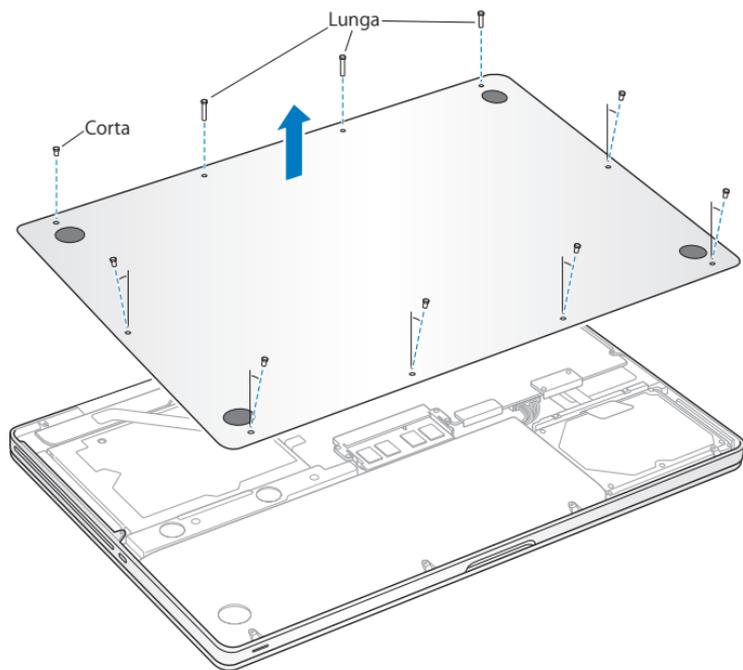
**Importante:** Quando rimuovi lo chassis inferiore, vengono esposti delicati componenti interni che possono presentare elettricità statica.
