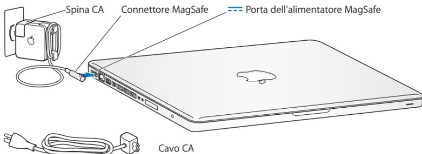
Per aumentare la portata dell'alimentatore di corrente, sostituisci la spina CA con il cavo a corrente alternata. Rimuovi innanzitutto la spina CA dall'alimentatore, quindi collega il cavo CA fornito con il computer all'alimentatore, verificando che sia ben saldo.
