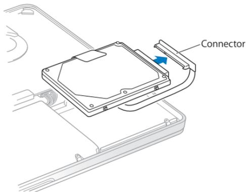
Il connettore è collegato a un cavo e rimane nell'alloggiamento dell'unità disco rigido.
