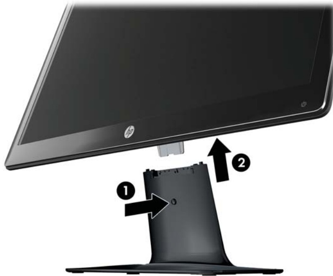
Abbildung 3-10 Entfernen des Monitorbildschirms
