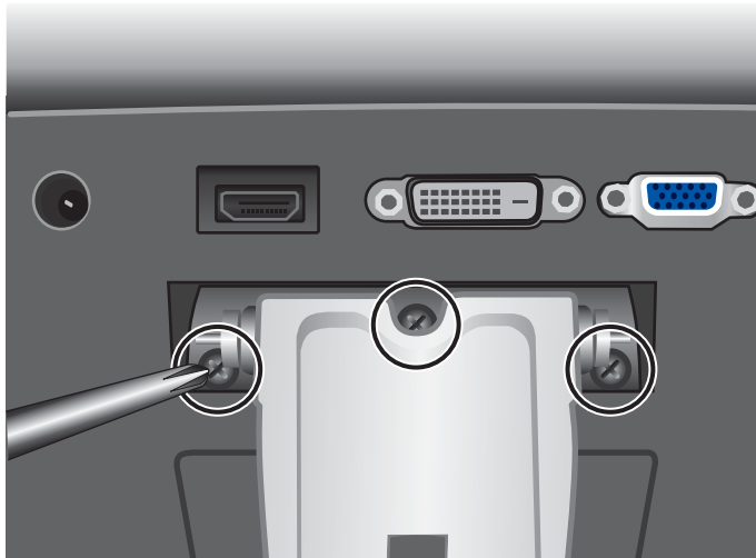
Abbildung 3-12 Entfernen der Schrauben an der Gelenkhalterung
