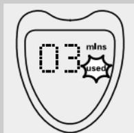
► Quando spegnete il rasoio, sul display appare il numero di minuti utilizzati. Viene visualizzato il testo "mins used" (la parola "used" lampeggia).
