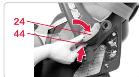
↘ Со стороны двери автомобиля откиньте D-SIP® **24** на шарнире дуги вверх, пока он не зафиксируется. ЩЕЛК!
