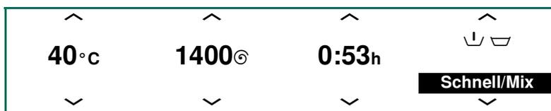
Das gespeicherte Programm kann mit der Taste unter dem Programm geändert werden, solange der Pfeil angezeigt wird.
