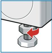
1. Kontermutter mit Schraubenschlüssel im Uhrzeigersinn lösen.
