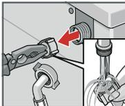
Sieb mit Zange herausnehmen und reinigen.
