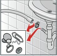
2. Schlauchschelle lösen, Ablaufschlauch vorsichtig abziehen.
