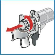
3. Alle 4 Transportsicherungsschrauben lösen und entfernen.
