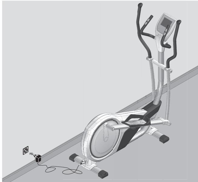
**D** Bei Geräten mit Netzteil: **Achtung!** Betrieb nur mit mitgeliefertem Original-Netzteil der Original-KETTLER-Ersatzteil (siehe Ersatzteilliste) zulässig. **Ansonsten Gefahr der Beschädigung.**
