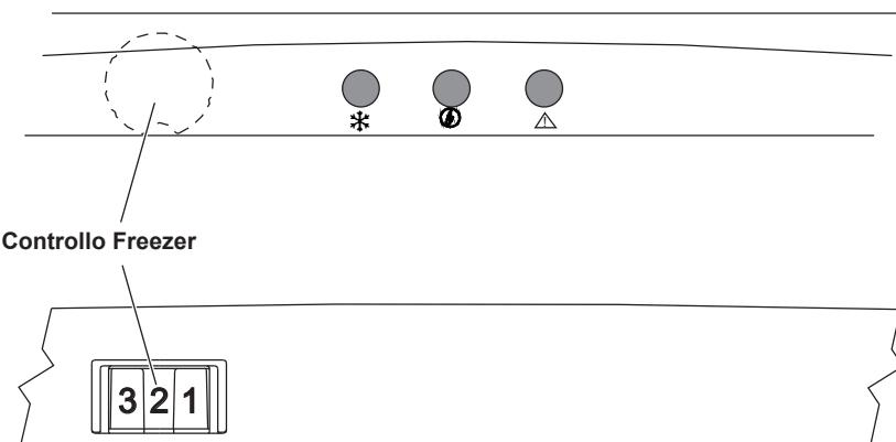
Il termostato del freezer regola automaticamente la temperatura interna degli scomparti. Ruotando la manopola da 1 a 5 è possibile ottenere temperature più fredde.
