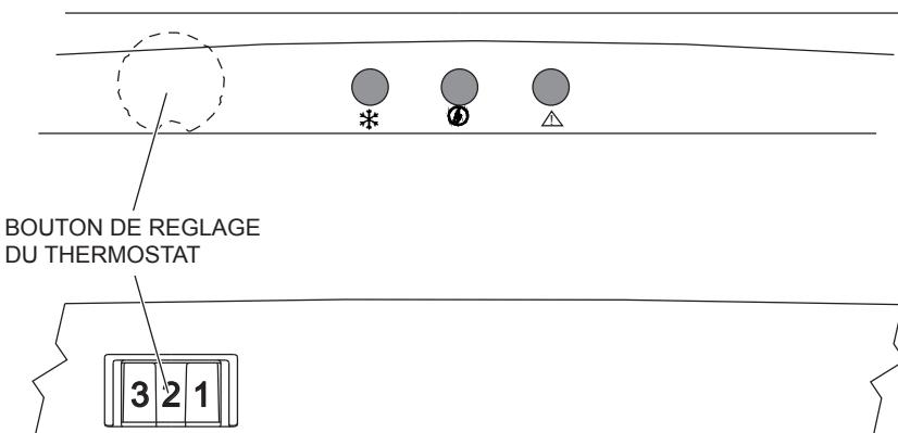
Le thermostat du congélateur régule automatiquement la température interne des compartiments. En tournant le bouton de la position 1 vers la position 5, vous pouvez obtenir des températures de plus en plus froides.
