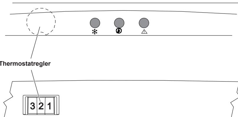
Das Thermostat regelt automatisch die Innentemperatur der einzelnen Fächer. Wenn Sie den Regler von Position «1» auf «5» drehen, erhalten Sie tiefere Temperaturen.
