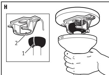
**(L)** Zur Befestigung des Schirms an der Lampe den Hals des Schirms in die Lampe einsetzen. Mittels Schraubbewegung festdrehen, bis der Schirm «einrastet».
