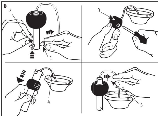
**(E)** Faites passer le tube de suspension à travers le couvercle du ventilateur et celui du dispositif de raccord. Faites ensuite passer câble et fiche à travers le tube de suspension et la boule de sécurité.
