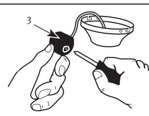
**(E)** Far passare il raccordo di sospensione attraverso il rosone del ventilatore e dell'aggancio. Far passare il cavo e la spina attraverso il raccordo di sospensione e la sfera di sicurezza.
