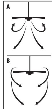
**Hinweis:** Ventilator ausschalten und zum Stillstand kommen lassen, bevor die Vorwärts/Rückwärts-Einstellung des Schiebeschalters geändert wird.
