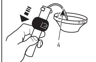
**(E)** Das Hängerohr durch die Ventilator- und Kupplungsabdeckung führen. Die Kabel und Stecker vorsichtig durch das Hängerohr und die Sicherungskugel führen.
