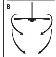
**Avvertenza:** spegnere il ventilatore e attendere che si sia completamente arrestato prima di modificare la direzione di rotazione con l'apposito interruttore.
