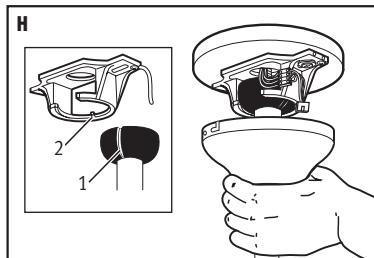
**(L)** Per fissare il paralume alla lampada, inserire il collo del paralume nella lampada. Avvitare il paralume finché si innesta in posizione.
