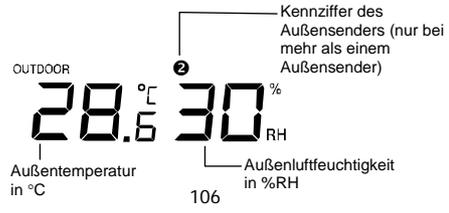
Die letzte Sektion des LCD-Bildschirms zeigt die Außentemperatur und die Außenluftfeuchtigkeit. Wird mehr als ein Außensender verwendet, so kommt hier auch die Kennziffer des empfangenen Außensenders zur Anzeige.
