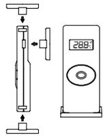
Der Außensender ist mit einer Konsole ausgerüstet, die mithilfe zweier mitgelieferter Schrauben an eine Wand montiert werden kann. Mithilfe der an der Unterseite des Außensenders fixierbaren Konsole kann dieser auch auf jeder ebenen Fläche aufgestellt werden.
