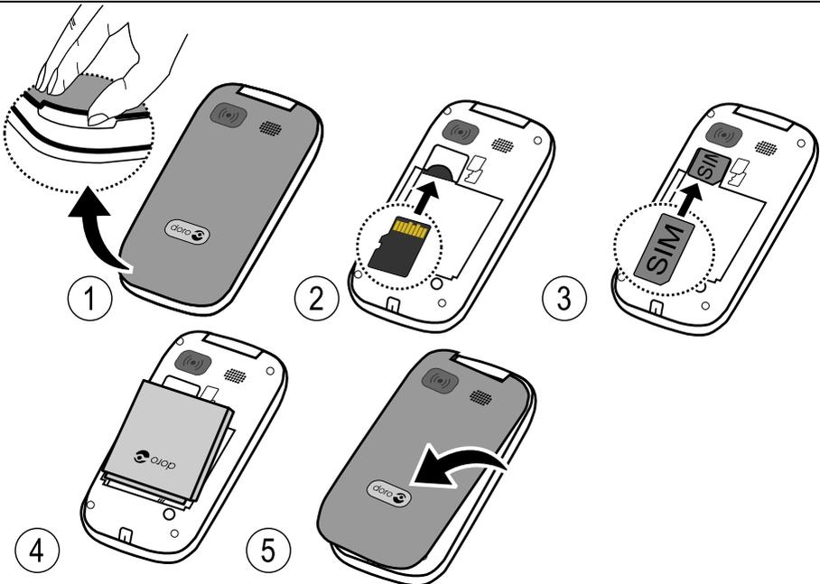
1. Entfernen Sie die Abdeckung des Akkufaches und den Akku, sofern dieser bereits eingelegt ist.
