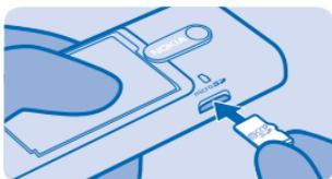
**!** **Important :** Ne retirez pas la carte de stockage qui est utilisée par une application. Cela risque d'endommager l'appareil et la carte de stockage, ainsi que les données stockées sur celle-ci.
