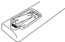
Nehmen Sie die Batteriekappe von der Rückseite der Fernbedienung ab und legen Sie zwei Batterien (Größe AAA) mit der richtigen Polung  $\oplus$  und  $\ominus$  ein.
