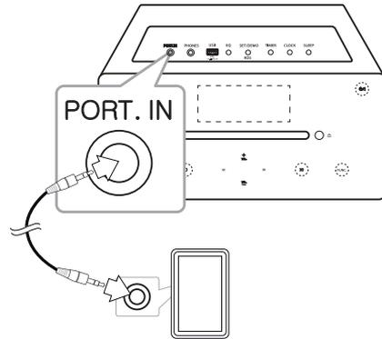
1. Schließen Sie das Zusatzgerät am Anschluss **PORT. IN** des Gerätes an.
