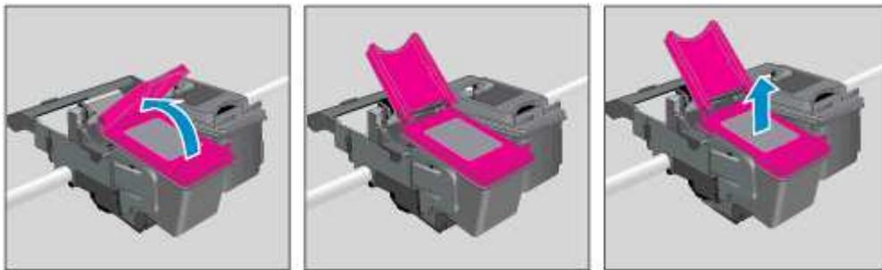
4. Halten Sie die Tintenpatrone an den Seiten mit der Unterseite nach oben fest, und suchen Sie nach den elektrischen Kontakten an der Tintenpatrone. Die elektrischen Kontakte sind die kleinen goldfarbenen Punkte auf der Tintenpatrone.
