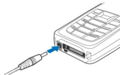
È possibile utilizzare il telefono cellulare mentre il caricabatterie è collegato. Il tempo di carica dipende dal tipo di caricabatterie e di batteria utilizzati. Ad esempio, per completare la carica di una batteria BL-5C utilizzando il caricabatterie ACP-7, occorre un massimo di 3 ore in modalità di attesa.
