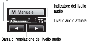
Regolazione manuale del livello audio
