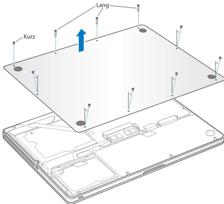
**Wichtig:** Durch das Entfernen des Gehäusebodens werden empfindliche interne Komponenten zugänglich, die durch elektrostatische Entladungen beschädigt werden können.
