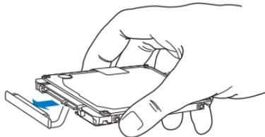
Der Stecker befindet sich an einem Kabel und verbleibt im Festplattenfach.
