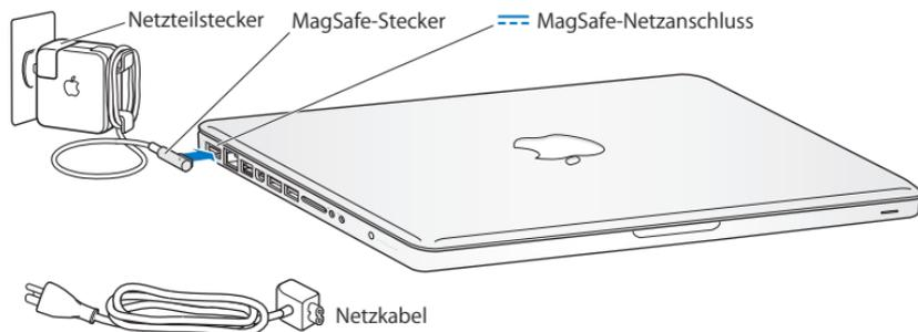
Bei Bedarf können Sie ein Verlängerungskabel an das Netzteil anschließen. Ziehen Sie dazu zuerst den Netzteilstecker nach oben vom Netzteil ab. Schließen Sie das mitgelieferte Netzteilstecker an das Netzteil an und vergewissern Sie sich, dass es korrekt sitzt.
