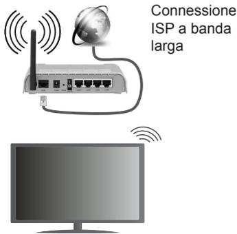
Per aumentare la larghezza di banda, è previsto un router N-wireless (IEEE 802.11a/b/g/n) con bande 2.4 e 5 GHz simultanee. Ottimizzato per uno streaming video HD più fluido e più veloce, trasferimenti file e gioco HD.
