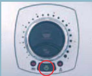
Wenn die Kontrolllampe konstant leuchtet, ist die Maschine zur Dampfabgabe bereit.
