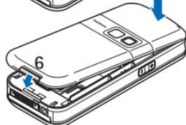
Per rimuovere la batteria, sollevare l'estremità inferiore della batteria estraendola dallo scomparto (7).
