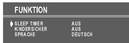
Die letzte Minute im Countdown des Sleep Timer wird links oben automatisch eingeblendet. Die Anzeige erlischt, wenn der Sleep Timer abgelaufen ist. Anschließend schaltet das TV-Gerät automatisch in den Bereitschaftsmodus.
