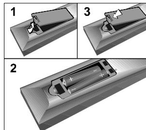
**HINWEIS:** Nehmen Sie die Batterien aus der Fernbedienung heraus, wenn das Gerät längere Zeit nicht benutzt wird. Die Fernbedienung könnte andernfalls durch auslaufende Batterien beschädigt werden.
