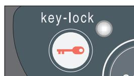
I: Se la spia luminosa KEY-LOCK si accende, è stato attivato il dispositivo di sicurezza.
