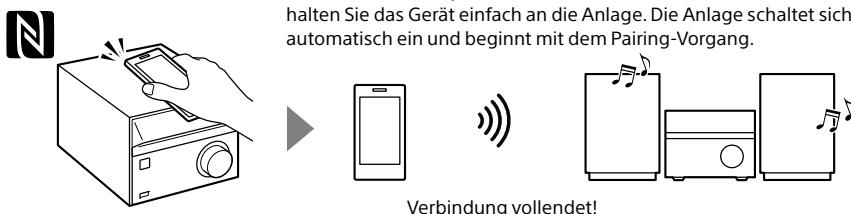
Wenn Sie ein Smartphone/Tablet mit einer NFC-Funktion haben, halten Sie das Gerät einfach an die Anlage. Die Anlage schaltet sich automatisch ein und beginnt mit dem Pairing-Vorgang.
