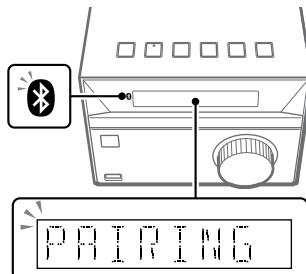
„PAIRING“ blinkt auf dem Display [10], und die Anzeige (BLUETOOTH) [3] blinkt schnell.
