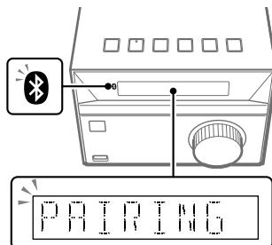
"PAIRING" parpadea en el visualizador [10] y el indicador  $\textcircled{3}$  (BLUETOOTH) [3] parpadea rápidamente.
