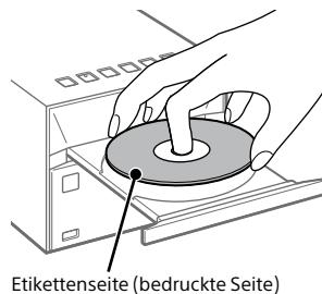
3 Drücken Sie ▲ [9] am Hauptgerät, um die Disclade [11] zu schließen.
