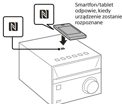
Wykonaj polecenia wyświetlane na ekranie, aby nawiązać połączenie. Po nawiązaniu połączenia BLUETOOTH, na wyświetlaczu **[10]** pojawi się napis „BT AUDIO”.
