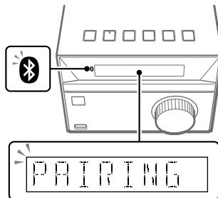
"PAIRING" knippert op het display [10] en knippert de (BLUETOOTH-)indicator [3] snel.
