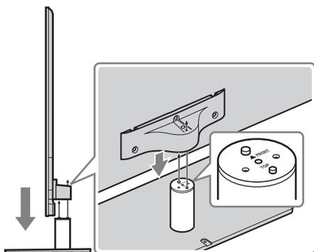
**2** Fixe o televisor e o suporte de fixação para mesas com o parafuso e a chave hexagonal fornecidos.
