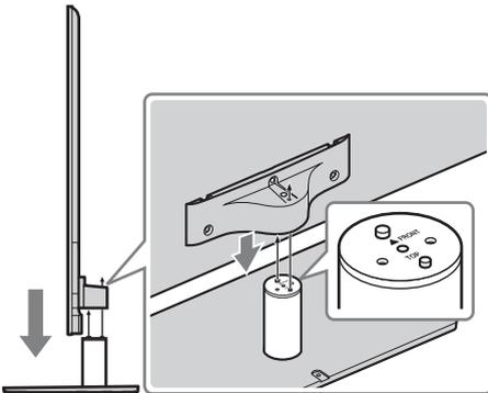
**2** Befestigen Sie das Fernsehgerät mit der mitgelieferten Schraube und dem Sechskantschlüssel am Tischständer.
